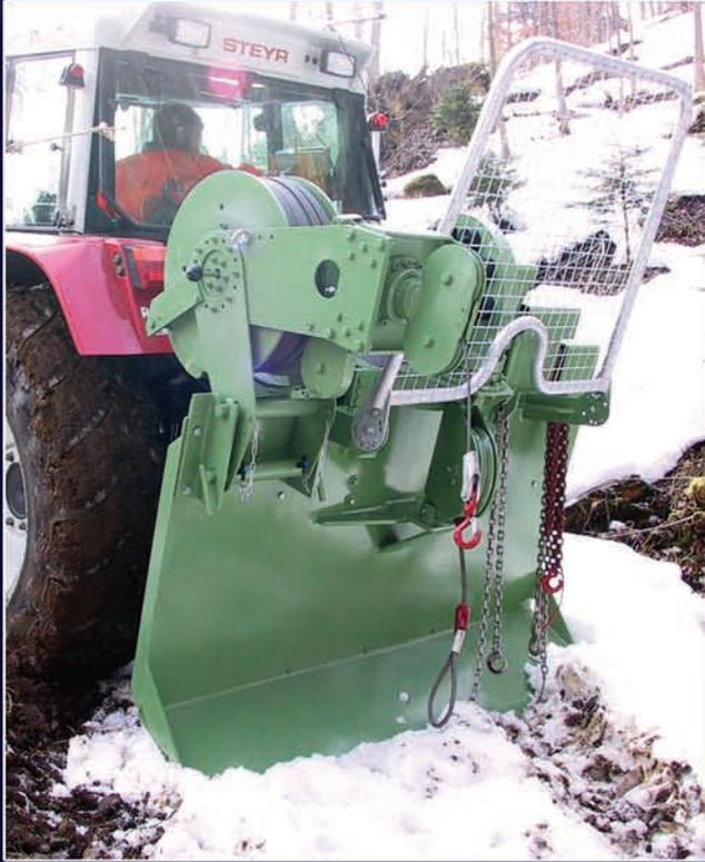
**Der Anbau** erfolgt in kürzester Zeit an ein genormtes Dreipunktgestänge der Kategorie 1 / 2 oder 3. Der Antrieb ab Zapfwelle des Fahrzeuges über Gelenkwelle bleibt während den Rückarbeiten eingeschaltet.
